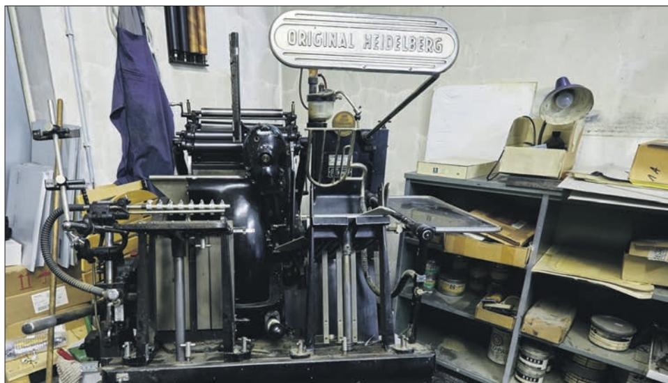
Der „Original Heidelberg“ Tiegel von 1951 druckt oder prägt im Buchdruckverfahren und war ein Jubiläumsstück des Druckmaschinenherstellers, wie die Messingplakette (kleines Foto re.) zeigt.
