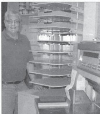
Noch herrscht Ruhe an der Falzmaschine. Mit dem turmartigen Gerät faltet Hans-Rudolf Roth die bedruckten Seiten – heraus kommen die fertig zusammengelegten Exemplare.
