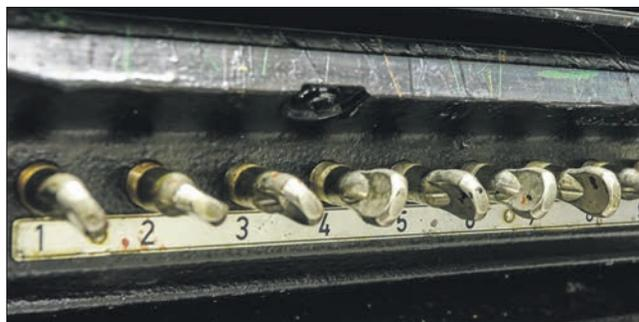
Wie Teile eines Instruments sehen die Zonenschrauben aus, mit deren Hilfe der Drucker die Farbmenge reguliert. Fotos: Rainer Grett
